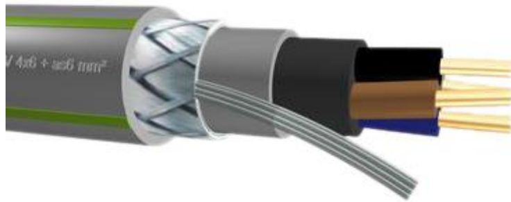
Figuur 34 Voorbeeld van een distributiekabel 4 x 6 mm 2 , dit is type YMeKasz OV 0,6 / 1 kV
