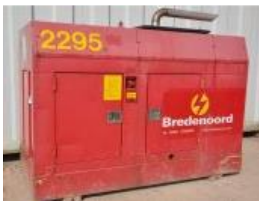
Figuur 37 Voor grotere aggregaten geldt: de aardelektrode is de enige bewuste veilige keuze
