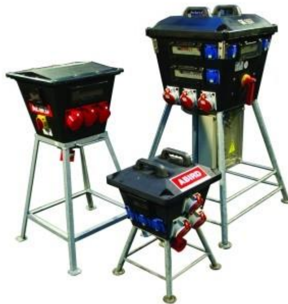
Figuur 18 De omhulling van een verdeelinrichting op een bouwlocatie is vaak in kunststof of volrubber uitgevoerd. Hiermee wordt beschermd tegen zowel directe als indirecte aanraking; dubbel geïsoleerd
