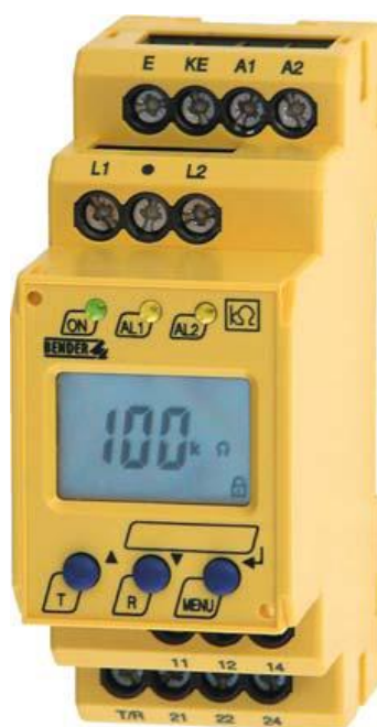
Figuur 76 Isolatiebewaking Bender met een AMP-meetmethode, d.w.z. ongevoelig voor DC-stromen en capacatieve lekstromen
