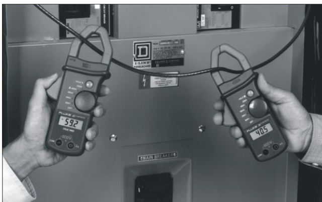
Figuur 183 De linkse A-meter is een type TRUE RMS, de rechtse A-meter niet
