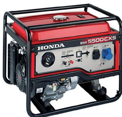
Figuur 36 Nog net draagbaar, met een vermogen van 4,5 kVA, deze uitvoering moet dus aanvullend worden beveiligd. Isolatiebewaking kan hier een bewuste veilige keuze zijn mits het een installatie van beperkte omvang is die hooguit voor enkele dagen op de locatie wordt gebruikt
