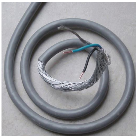
Figuur 15 Kabel met ongeïsoleerde uiteinden; op de actieve delen, hier de blanke uiteinden van de koperdraden, kan spanning staan
