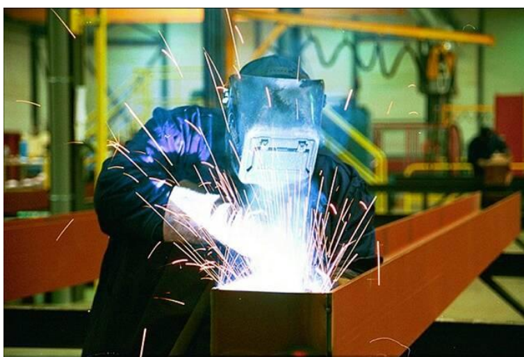
Figuur 146: Elektrisch lassen alleen met aanwijzing VOP
