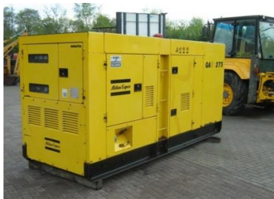
Figuur 37 Voor grotere aggregaten geldt: de aardelektrode is de enige bewuste veilige keuze
