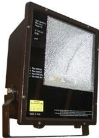
Figuur 102 Hqit lamp 400 W, klasse I IP 65 voor toepassing buiten handbereik
