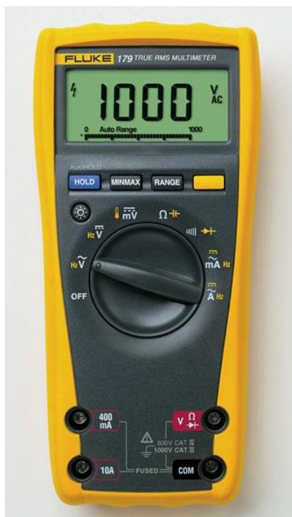
Figuur 167 TRUE-RMS CAT IV voltmeter in de stand V~
