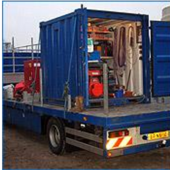
Figuur 39 Mobiele werkplaats met elektriciteitsvoorziening
