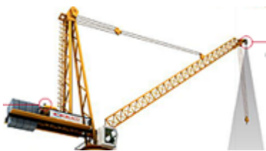
Figuur 5.4.5-2 Camerasysteem in een top-torenkraan
