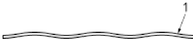
Afbeelding 3 De lokale boog (ook wel rollerwave verstoring genoemd)
